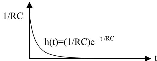
2) Pour obtenir la réponse indicielle, on utilise le produit de convolution comme pour n'importe quel signal. Pour un signal d'entrée  $e(t)$ , cette réponse est définie par :
