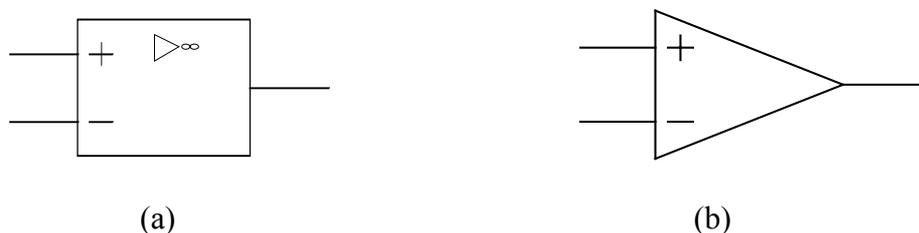
**Figure 1.** Symboles de l'Amplificateur Opérationnel.
