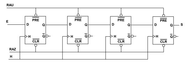
En rebouclant la sortie de la dernière bascule sur l'entrée de la première, on obtient ce qu'on appelle un "**compteur en anneau**". Pour charger une donnée 4 bits initiale sur les entrées D des bascules, il faut ajouter une logique de commande composée de quelques portes supplémentaires. Cette donnée se retrouver cycliquement sur les mêmes bascules.
