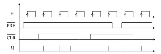
Quand les entrées asynchrones sont inactives (=1), la bascule JK fonctionne en diviseur de fréquence par deux (J=K=1 : la sortie change d'état à chaque front actif de l'horloge).
