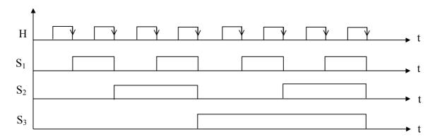
On affecte les poids 1, 2, 4 aux sorties  $S_1$ ,  $S_2$ ,  $S_3$  des bascules. On considère qu'au départ toutes les sorties sont à zéro. On obtient le tableau suivant (il y a un changement d'état après chaque front descendant de l'horloge).
