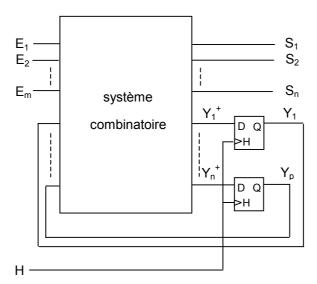
La plupart du temps, ce sont des bascules D qui sont utilisées, synchrones sur front.
