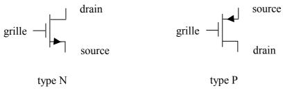
Le transistor de type N est commandé par une tension grille-source positive ou nulle ; le transistor de type P est commandé par une tension grille-source négative.
