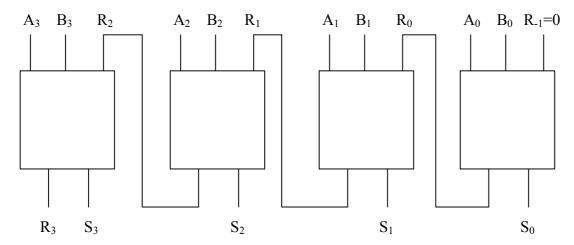
Cette architecture est intéressante d'un point de vue matériel car elle est répétitive. Par contre, le résultat obtenu dépend du nombre d'additionneurs donc de la taille des mots à additionner. La retenue  $R_1$  est délivrée après la première addition et ainsi de suite.
