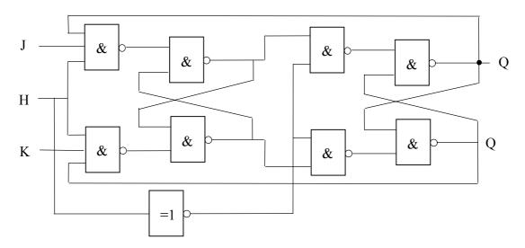
La bascule maître-esclave est donc une solution à l'oscillation existant pour la combinaison J=K=1. Une autre solution consiste à utiliser un déclenchement sur front (voir bascules synchrones, plus loin).
