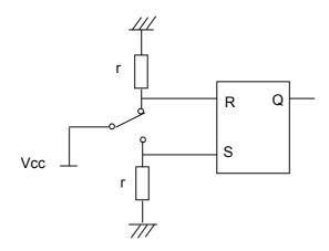
Quand le commutateur est en position haute, R=1 et S=0 donc Q=0. Quand il change de position, on passe par l'état R=S=0, donc on est dans l'état de mémorisation et les sorties ne changent pas. Quand il est en position basse, on a R=0 et S=1, donc Q=1.
