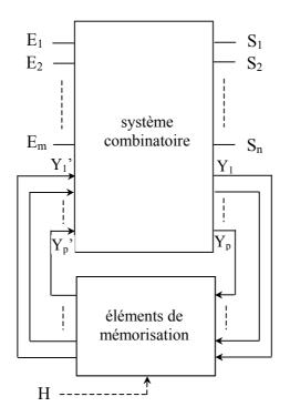
Système séquentiel à m entrées  $(E_1, E_2, ..., E_m)$ , n sorties  $(S_1, S_2, ..., S_n)$  et p variables internes  $(Y_1, Y_2, ..., Y_p)$
