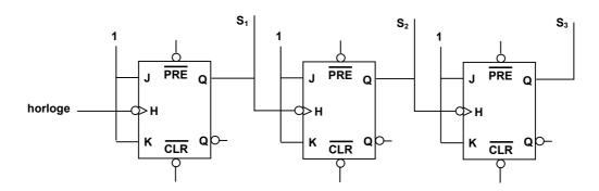
Les entrées de pré-positionnement sont inactives car elles sont placées au niveau haut. Les entrées J et K sont à 1 donc les bascules changent d'état à chaque front actif de leur horloge (front descendant). La bascule  $S_1$  change d'état à chaque front descendant de l'horloge externe, la bascule  $S_2$  à chaque front descendant de  $S_1$  et la bascule  $S_3$  à chaque front descendant de  $S_1$ .
