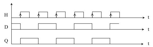
Au départ, Q=0 donc  $D = \overline{Q} = 1$ . Au 1<sup>er</sup> front montant d'horloge, la sortie Q recopie la valeur de D (=1) et  $\overline{Q}$  passe à 0. Au 2<sup>e</sup> front montant d'horloge, la sortie Q recopie de nouveau la valeur de D (=0) et  $\overline{Q}$  passe à 1, et ainsi de suite.
