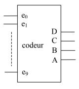
Par exemple si l'entrée  $e_6$  est active (N=6), le mot de sortie est (D,C,B,A) = (0,1,1,0).
