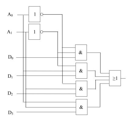
Exemple d'application d'un multiplexeur : réalisation d'une fonction quelconque
