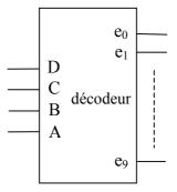
Par exemple, quand on a (D,C,B,A) = (0,0,1,1), la sortie d'indice 3  $(e_3)$  est à 1.
