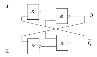
Par rapport à la bascule RS, l'intérêt est que l'état inutilisé devient utilisable. En effet, à la différence de la bascule RS, si J=K=1, les 2 sorties ne sont pas égales toutes les 2 à 1. Quand on arrive dans l'état J=K=1 à partir de l'un des 3 autres, on a donc forcément les 2 sorties complémentaires.
