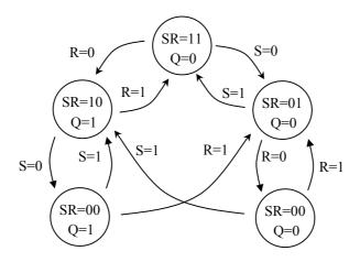
Ce mode de représentation permet la synthèse automatique de système séquentiels complexes. Il est utilisé par les méthodes de synthèse modernes.
