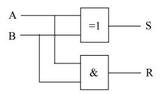
On appelle ce système logique un demi-additionneur, car il ne prend pas en compte une éventuelle retenue provenant du résultat de l'addition des 2 bits de rang directement inférieur.
